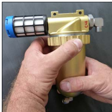
Fig. 1 - Loosen ring nut
